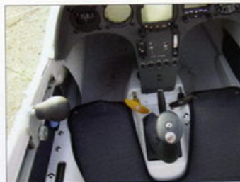
Vue du cockpit transformé: sur le bordé gauche, le levier supplémentaire permettant d'actionner le gouvernail à la main. Blick ins umgebaute Cockpit: An der linken Bordwand der Zusatzhebel, mit dem das Seitenruder von Hand bedient werden kann.
