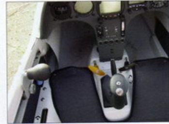
Vue du cockpit transformé: sur le bordé gauche, le levier supplémentaire permettant d'actionner le gouvernail à la main. Blick ins umgebaute Cockpit: An der linken Bordwand der Zusatzhebel, mit dem das Seitenrudder von Hand bedient werden kann.
